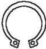
Communément appelés «circlips» ou segments d'arrêt, ces composants permettent d'immobiliser axialement un composant. Ils se placent dans une gorge (arbre ou alésage) et leur élasticité permet le montage et le maintien en position. solution simple et peu onéreuse, mais le positionnement axial n'est pas assuré de manière précise.
